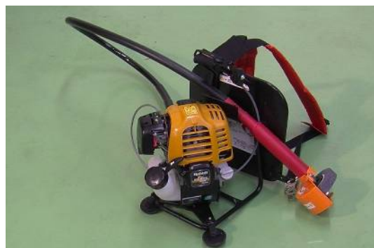
レール研磨盤 SK-62型(φ100)
