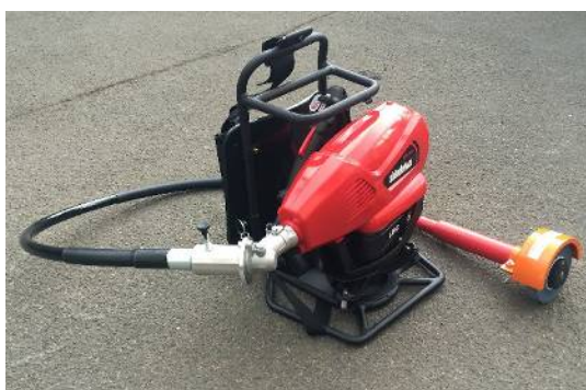
レール研磨盤 SK-7型(φ100)
